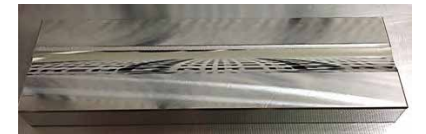
金属板の上に作られた最新型の回転楕円面形状の中性子スーパーミラーです。
