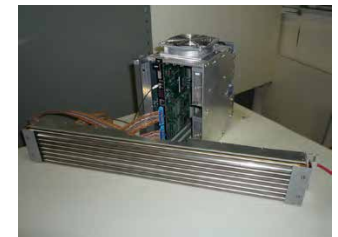
中性子計測用の検出器です。どの位置で検出されたか識別できる構造になっています。
