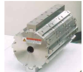
強力な永久磁石で組み上げた Halbach 型磁極構造の六極中性子磁気レンズです。
